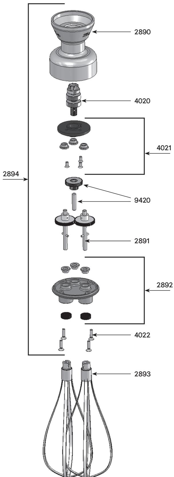
**Desmontaje de las varillas**
